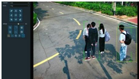
Mit der PTZ-Verfolgung markieren Sie eine Person im Bild und die PTZ-Kamera verfolgt diese automatisch.
